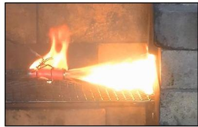
リチウムイオンバッテリーを加熱します。
