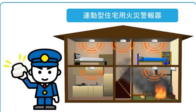
※交換の際は連動型住宅用火災警報器などの付加的な機能を併せ持つ機器へ交換します。
